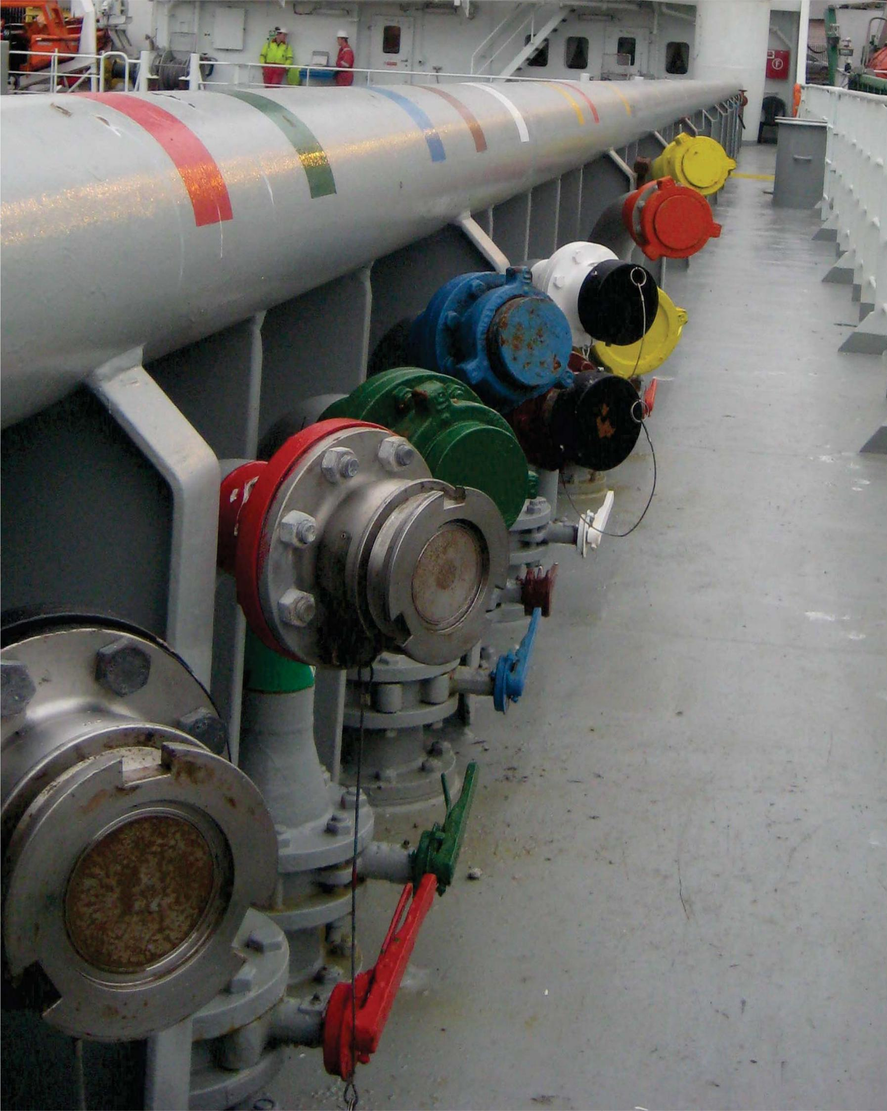
Bezúkapové spojky, známé také jako suché spojky, se od běžných spojek liší patentovanou konstrukcí a principem spojení, které splňuje požadavky na maximální bezpečnost, spolehlivost a ochranu životního prostředí.
